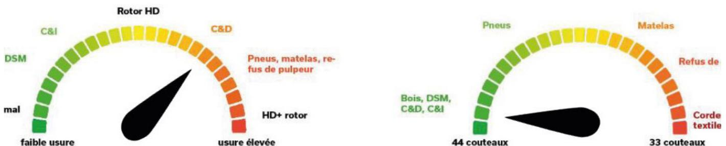
Les deux configurations des couteaux du rotor peuvent être utilisées pour les déchets C&D. Un nombre plus important de couteaux demande un couple plus élevé et plus de puissance pour faire tourner le rotor. Cela peut entraîner un renversement plus important du rotor à 44 couteaux, selon le type de déchets.
