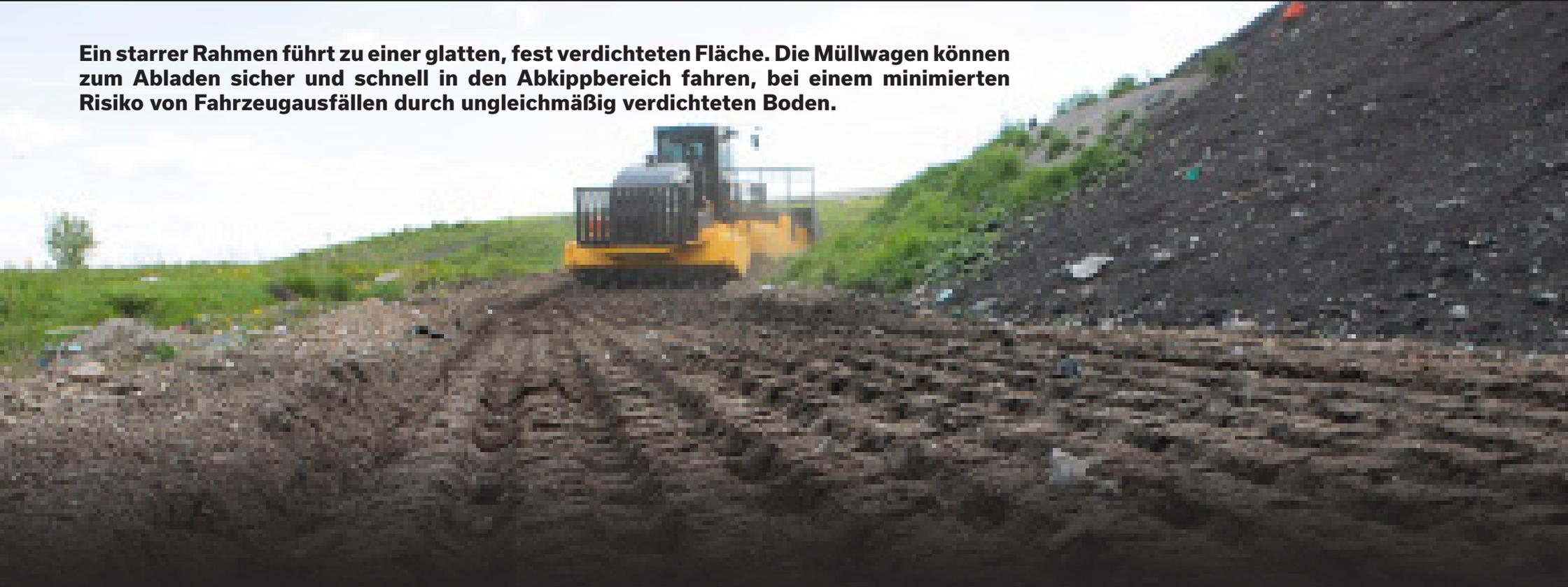
Der starre Rahmen eines TANA-Verdichters maximiert die Gewichtsverteilung der Verdichtung über einen Bereich mit ungleichmäßigen Unebenheiten.
