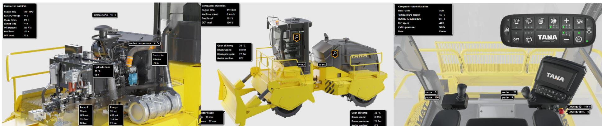
TANA ProTrack® bietet ein Tool, um den Status des Verdichters und Details der Aggregatkomponenten über das Internet in Echtzeit anzuzeigen.
